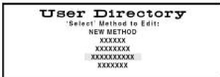
5.4.4 移动光标到 NEW METHOD，按 SELECT 键，即新建一个方法。移动光标到下面的已存在方法“\*\*\*\*\*”，按 SELECT 键，即可对该方法进行编辑修改。
