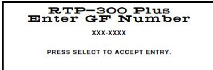
用数字键依次输入光纤温度传感器的 GF 号（见前图光纤 GF 号标记处），按 SELET 键确认即可。
